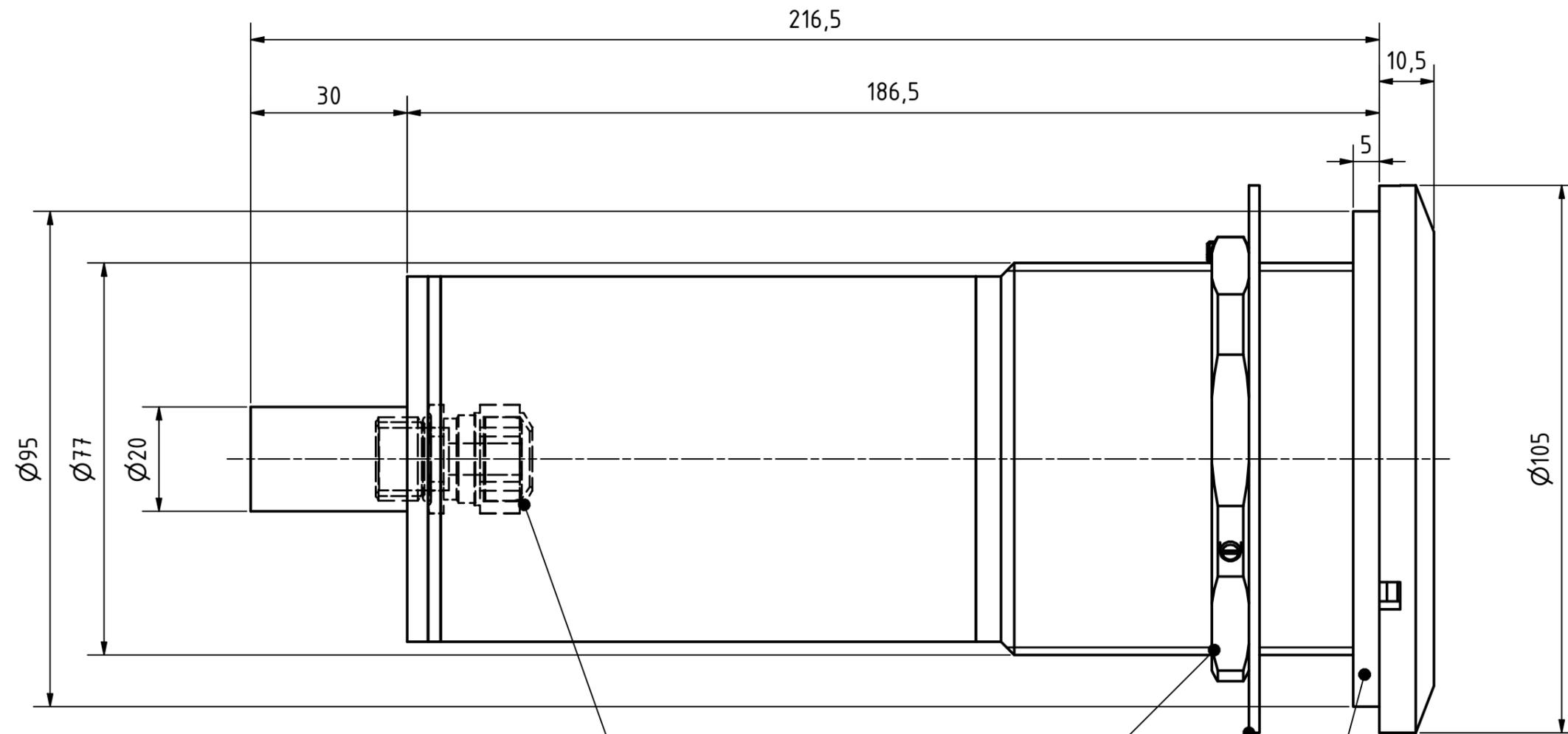
Kabelverschraubung M16x1.5 V4A
