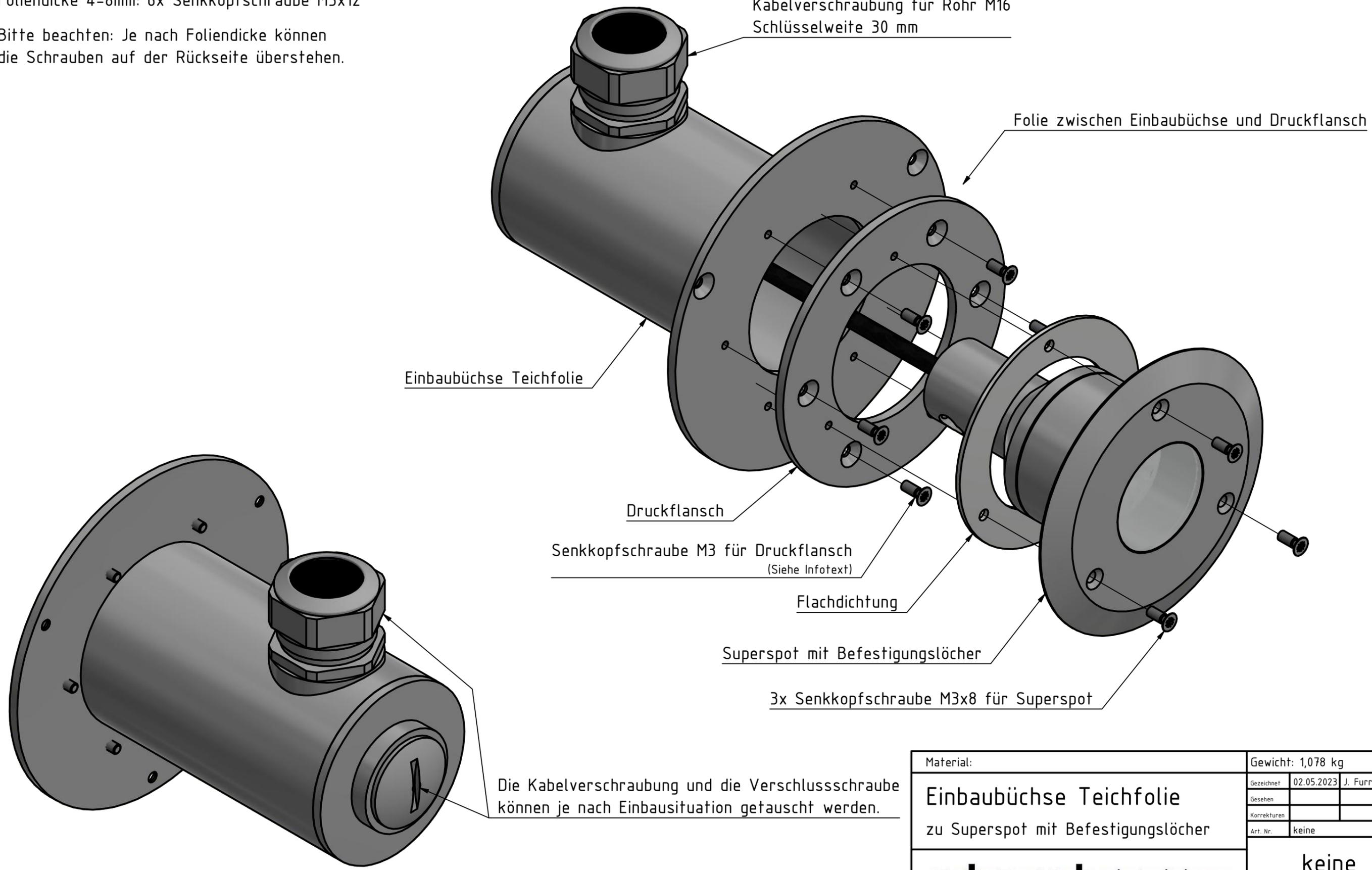
Kabelverschraubung für Rohr M16
